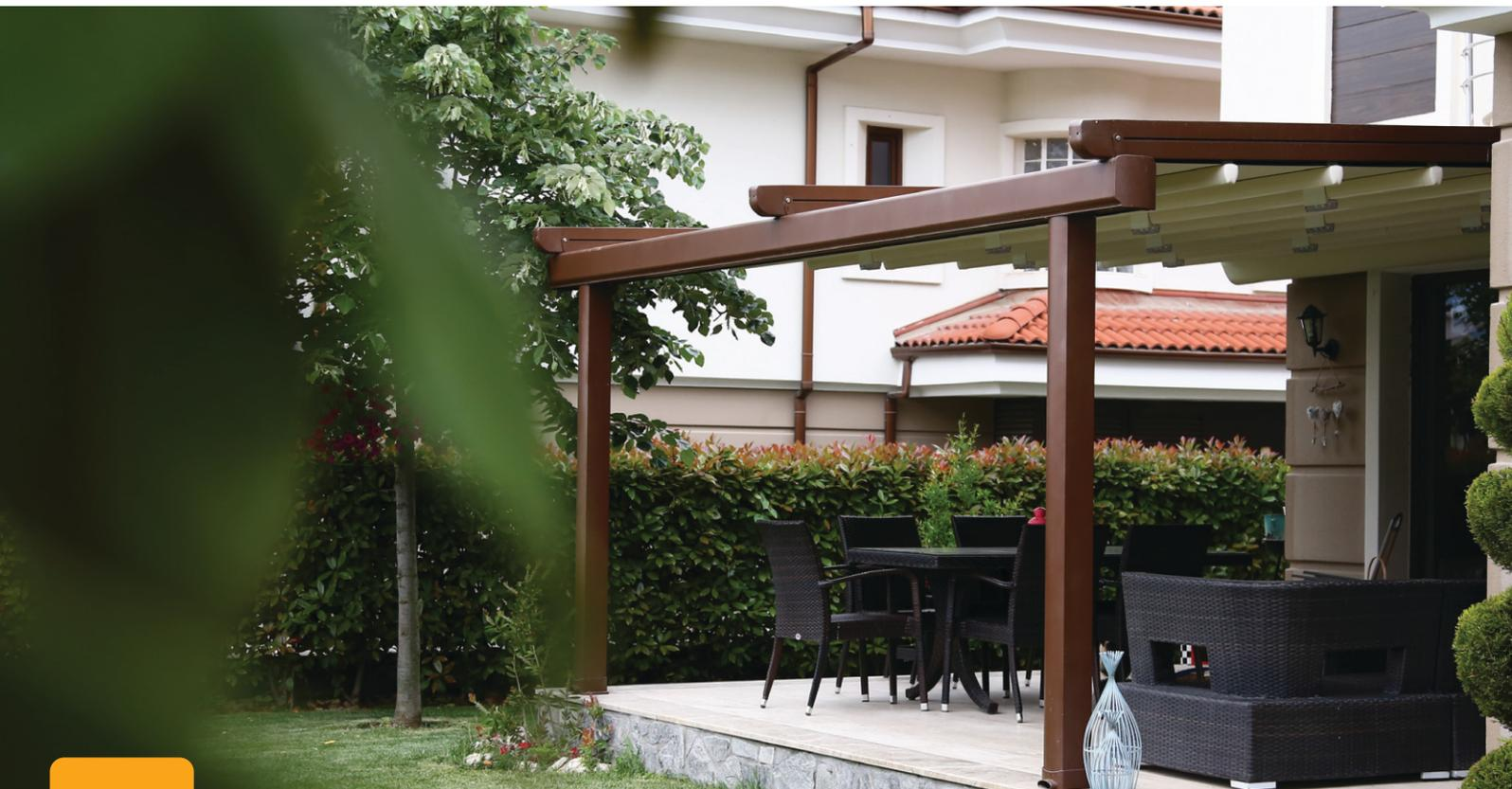
Die Standy-Pergola stellt eine Variante des Modells Primus dar. Der grundlegende Unterschied liegt im Montageprinzip. Diese Pergola verfügt sowohl an der Vorder- als auch an der Rückseite über Stützen, sodass ihre Montage keine Befestigung an der Wand des Objekts erfordert.
